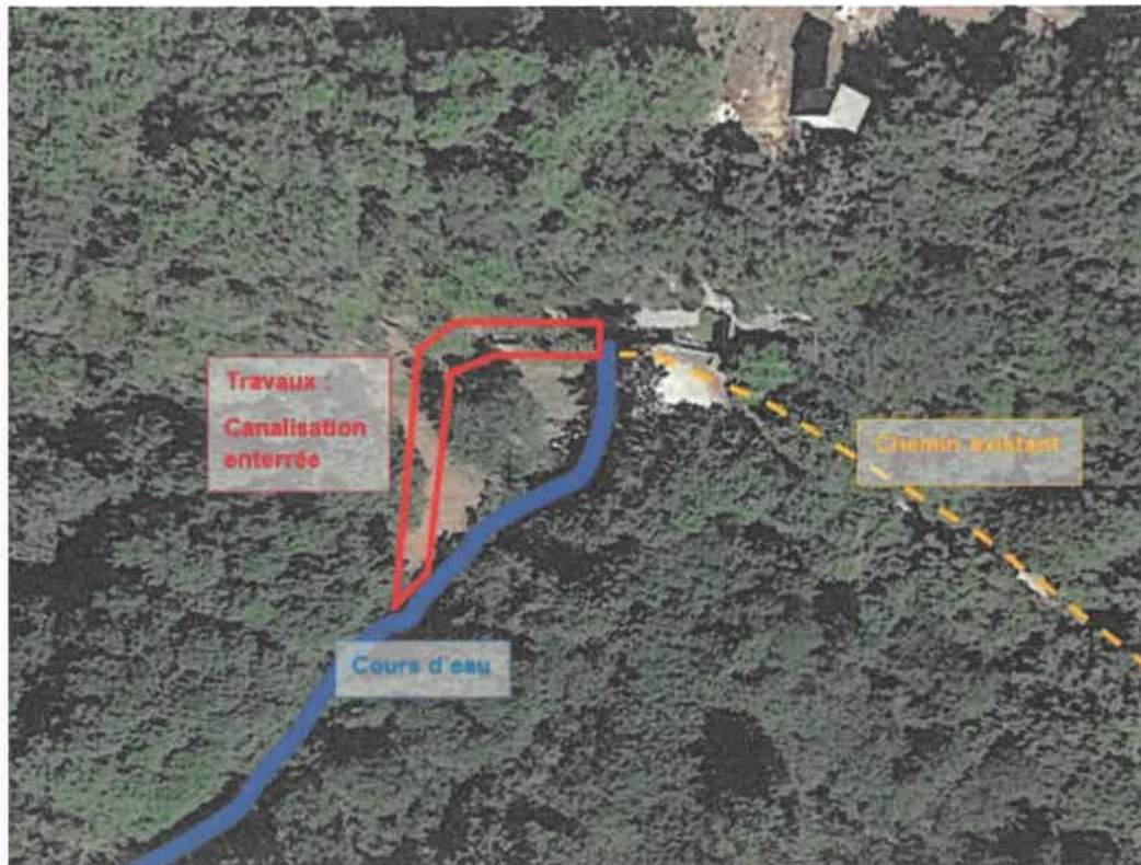
Annexe 6 : Zone de travaux à proximité de la source du Gros Roc (canalisation enterrée sur 32 ml à une profondeur de 50 cm)
