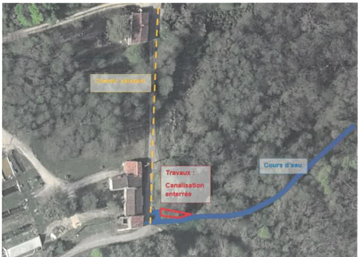
Annexe 7 : Zone de travaux à proximité de la pisciculture (canalisation enterrée sur 8 ml à une profondeur de 50 cm)
